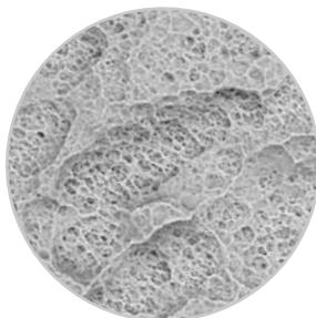
Микроструктура поверхности имплантата MIS C1 (увеличение в 2500 раз).
